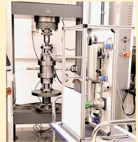
*Banc expérimental d'essais couplé de transfert gaz en cours de cisaillement d'une interface*
