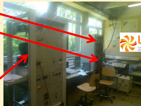
Banc de test Pile à Combustible / Supercondensateurs
